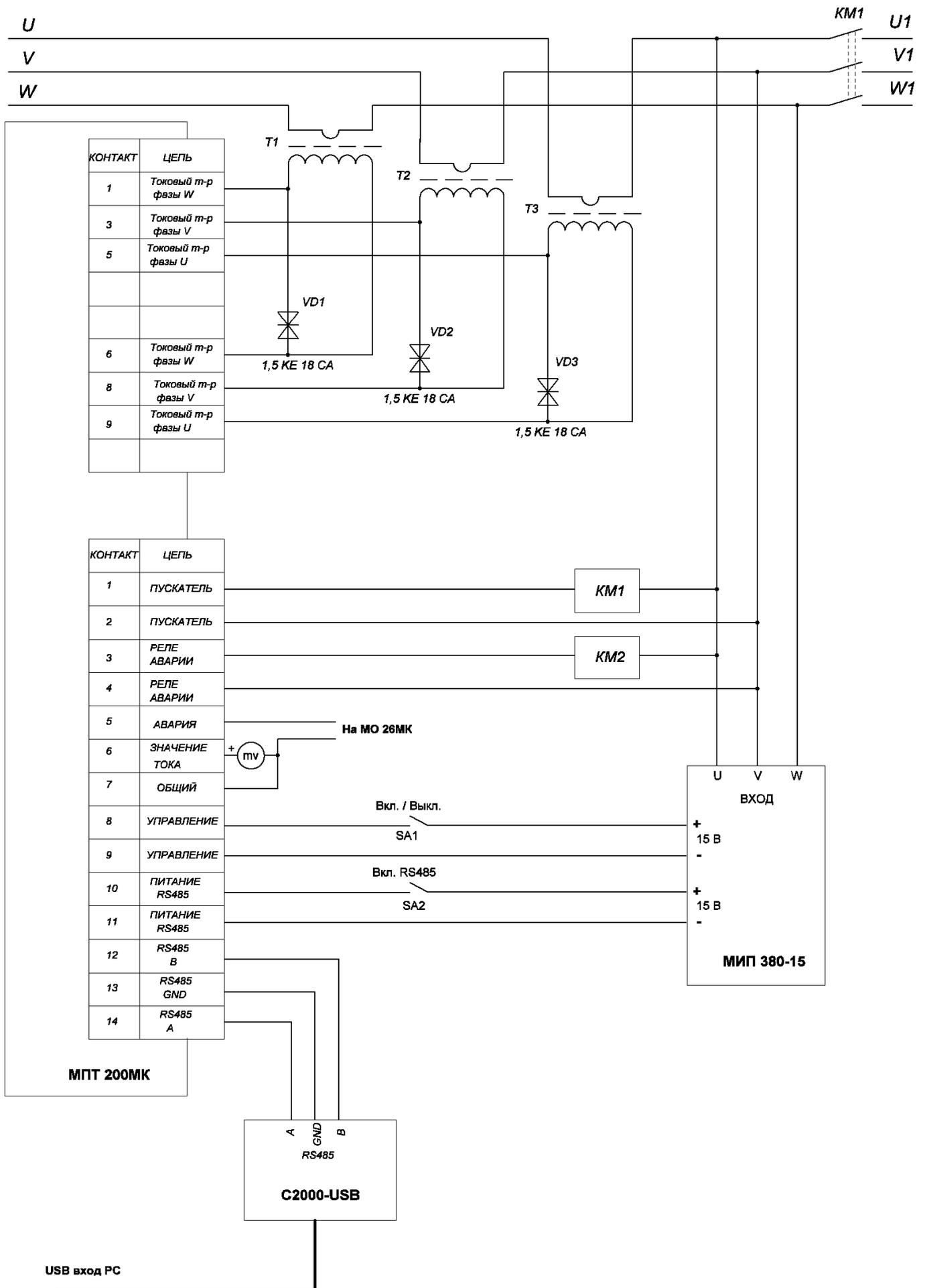
Рисунок 5.2 – Схема подключения МПП ХХХМК
