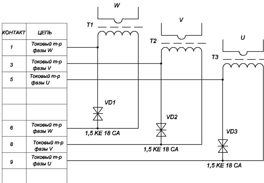
Вследствие сложности выполнения идентичности параметров каналов измерения, токовые трансформаторы помечаются и между собой не заменяются. Настройка правильности измерения производится предприятием изготовителем.
