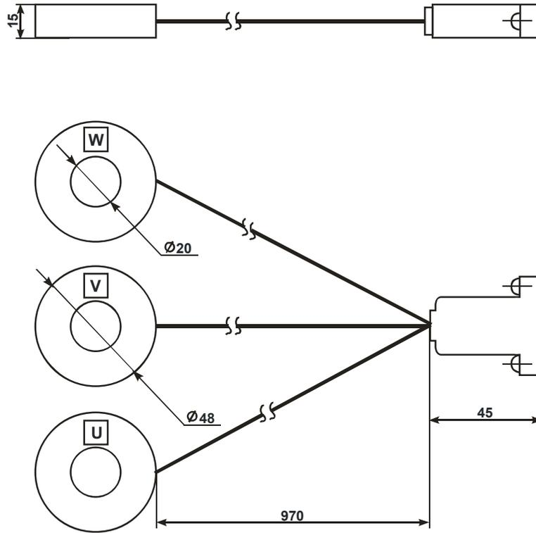
Рисунок 4.2 – Трансформатор тока с разъемом DB9 для подключения
