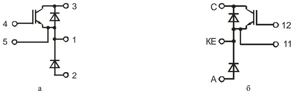
Рисунок 2 – Электрическая схема внутренних соединений модуля
