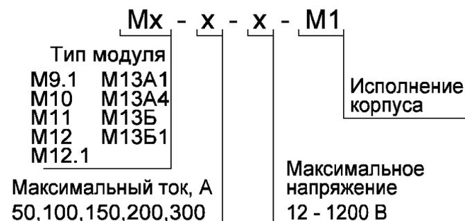
Рисунок 1.1 – Расшифровка названия модулей
